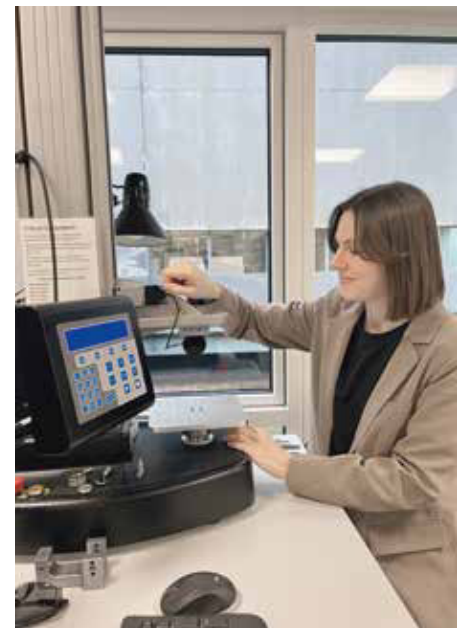
Artiklens forfatter er her ved at opsætte en såkaldt tensile-tester, som bruges til at teste medicinsk udstyr.
