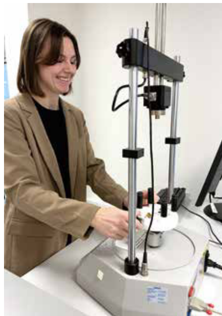
Artiklens forfatter er her ved at opsætte en såkaldt tensile-tester, som bruges til at teste medicinsk udstyr.
